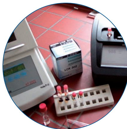
Fig. 6 : poste de mesure photométrique : thermostat HT 200S, test en cuve, photomètre DR 2800
