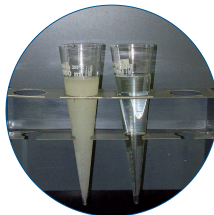
Fig. 5 : Comparatif clair : échantillons d'eaux usées au début et à la fin du traitement
